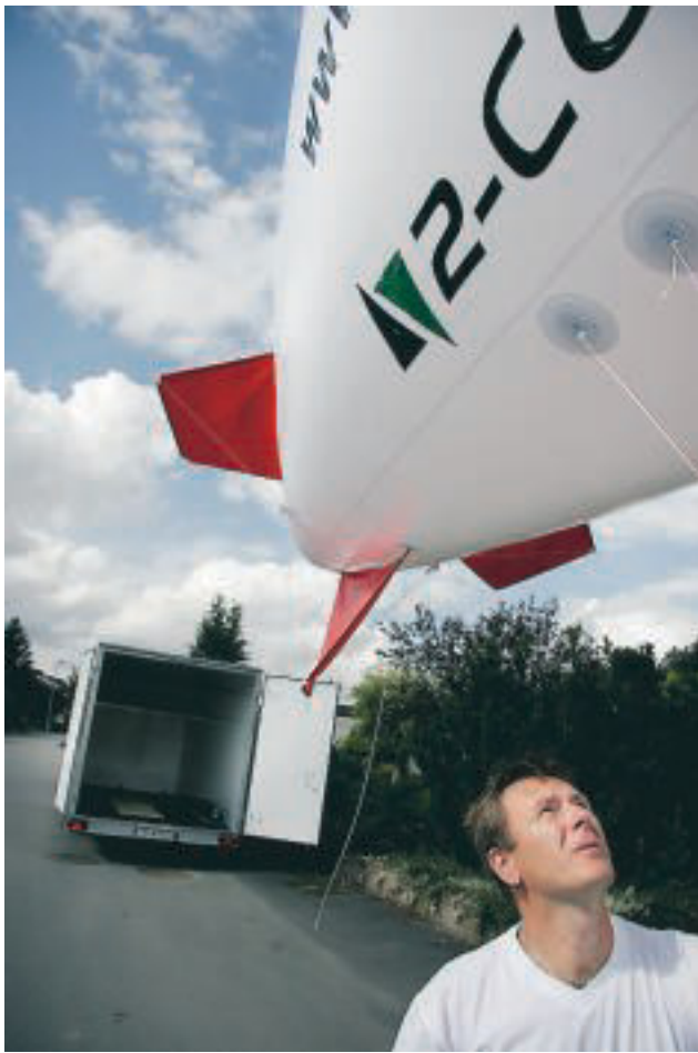
Attila Gál är flygfotografen som aldrig lämnar markytan. Istället skickar han upp en ballong med kamera och styr trådlöst. En annan metod är att sätta kameran på en teleskopmast (mitten) som pumpas 17 meter upp.
